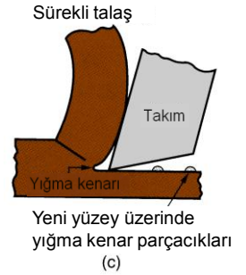
Şekil 21.9 (c) yığılma kenarlı sürekli talaş
