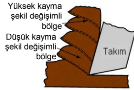
Şekil 21.9 (d) yarı kesintili talaş.
