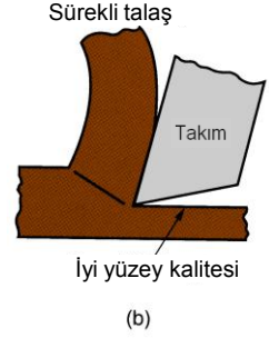
Şekil 21.9 (b) sürekli talaş
